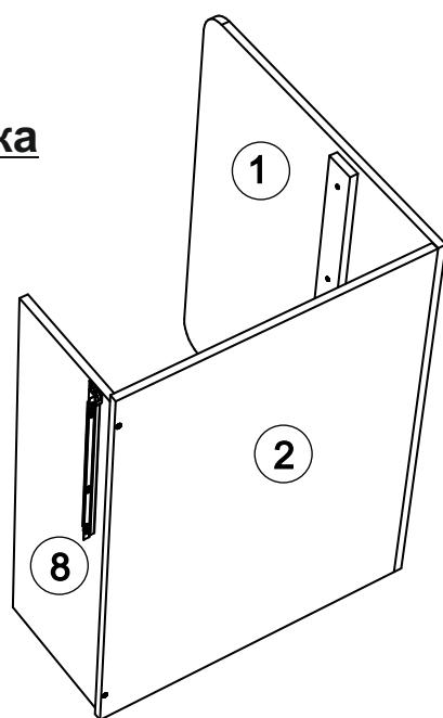
7. При помощи эксцентриковой стяжки и планки-13 соедините поочередно собранные ранее 2 конструкции.
