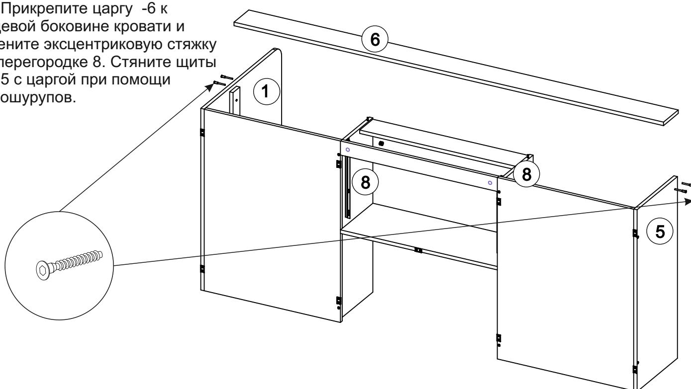
11. Поставьте кровать на основание и закрепите вторую царгу - 6 на 2 эксцентриковые стяжки с перегородками - 8 и 4 еврошурупами со щитами 1 и 5.
