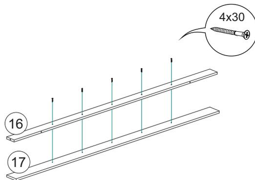
3. Сборка производится горизонтально, тыльной стороной вниз. Боковины №1 и №2 скрепить между собой вязкой №4 при помощи евровинтов 6х50 мм. цоколь №16 и сборку цоколей №16 и №17 соедините с вязкой №4 и боковинами №1 и №2 также при помощи евровинтов 6х50 мм. После этого к боковинам и цоколям прибейте по 2 подпятника к каждой гвоздями 2х20мм.
