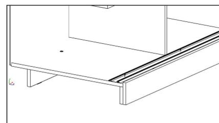
10. При помощи двойных эксцентриковых стяжек соберите декоративную обкладку из фальшпанелей №13, №14 и №15. В панели №13, №14 и №15 вверните эксцентрики.
