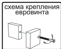
5. Далее устанавливаем вязки №8 внутри шкафа и закрепляем их так же евровинтами 6x50 мм. Установите полкодержатели.
