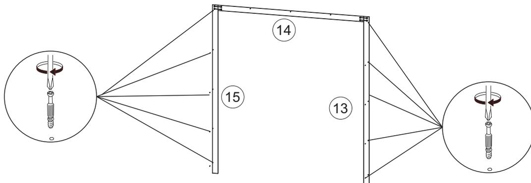
11. Закрепите собранную обкладку из панелей №13, №14, №15 на шкафу при помощи эксцентриковой стяжки закрепив её на боковинах №1, №2 и на крышке №3.
